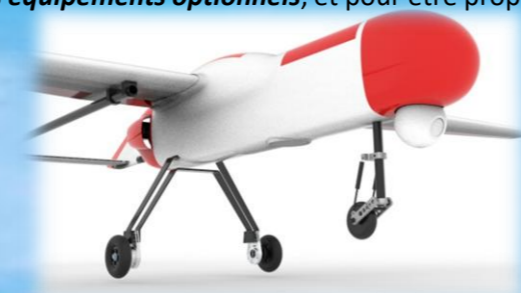
Version à moteur arrière unique (Push)
