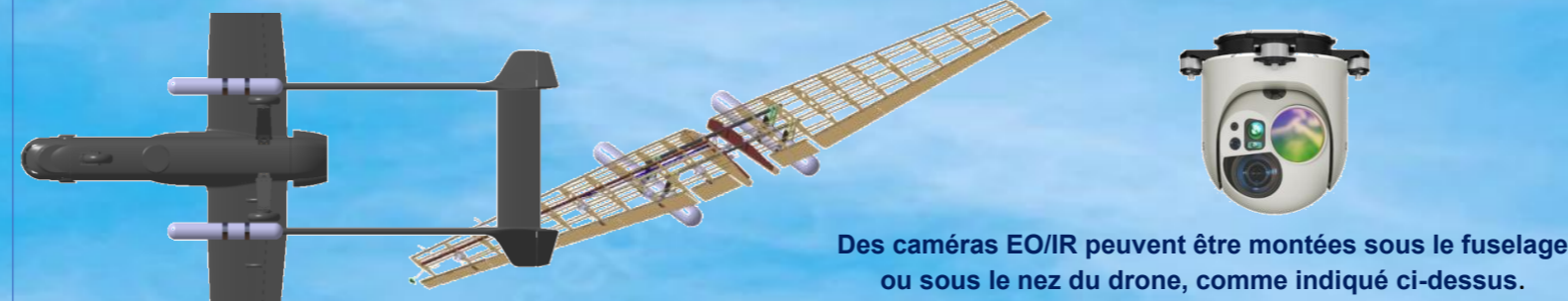
Des réservoirs de carburant supplémentaires pour augmenter l'autonomie et le rayon d'action peuvent être montés sous les ailes
