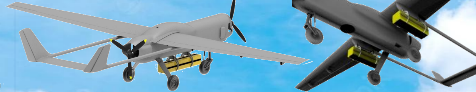
Le système de largage peut être ajouté sous les ailes pour larguer une double charge ou sous le fuselage pour une seule charge.
